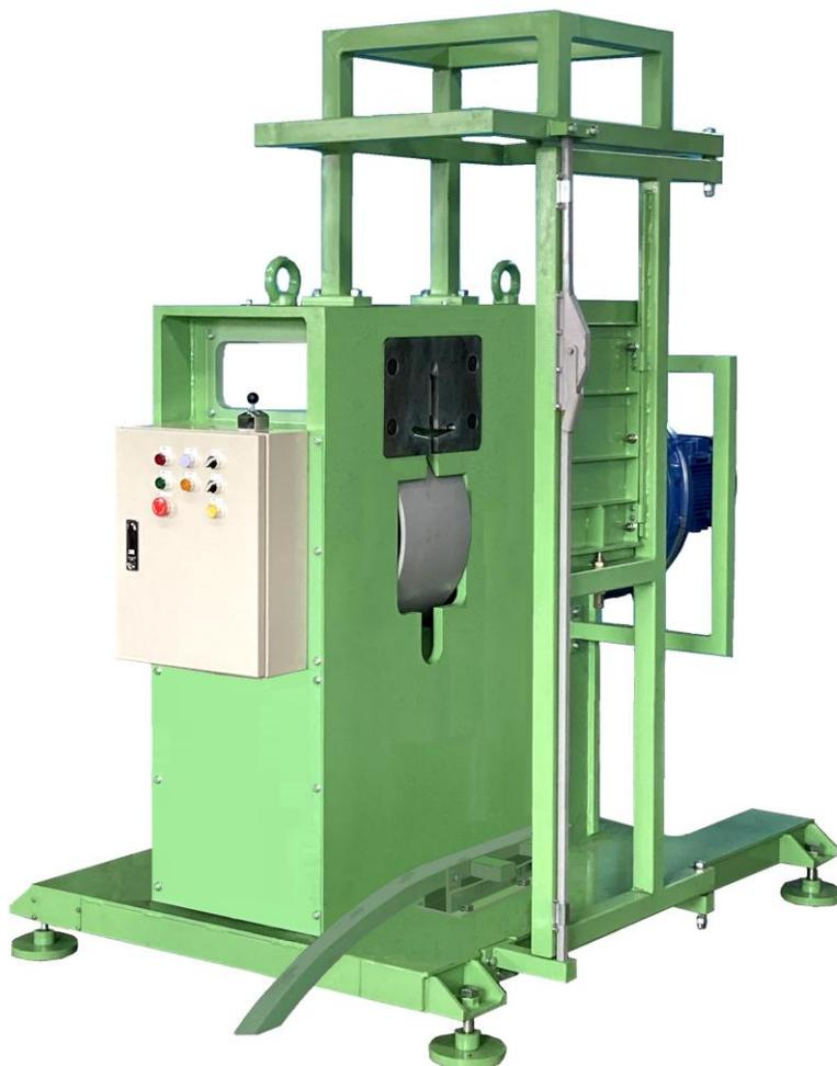
タイヤに入っているビードワイヤーを簡単に抜き取ることができ、その後のリサイクル処理の効率アップを図ります。回転を利用して抜き取る為、直動式に比べコンパクトで、大きなスペースがありません。
